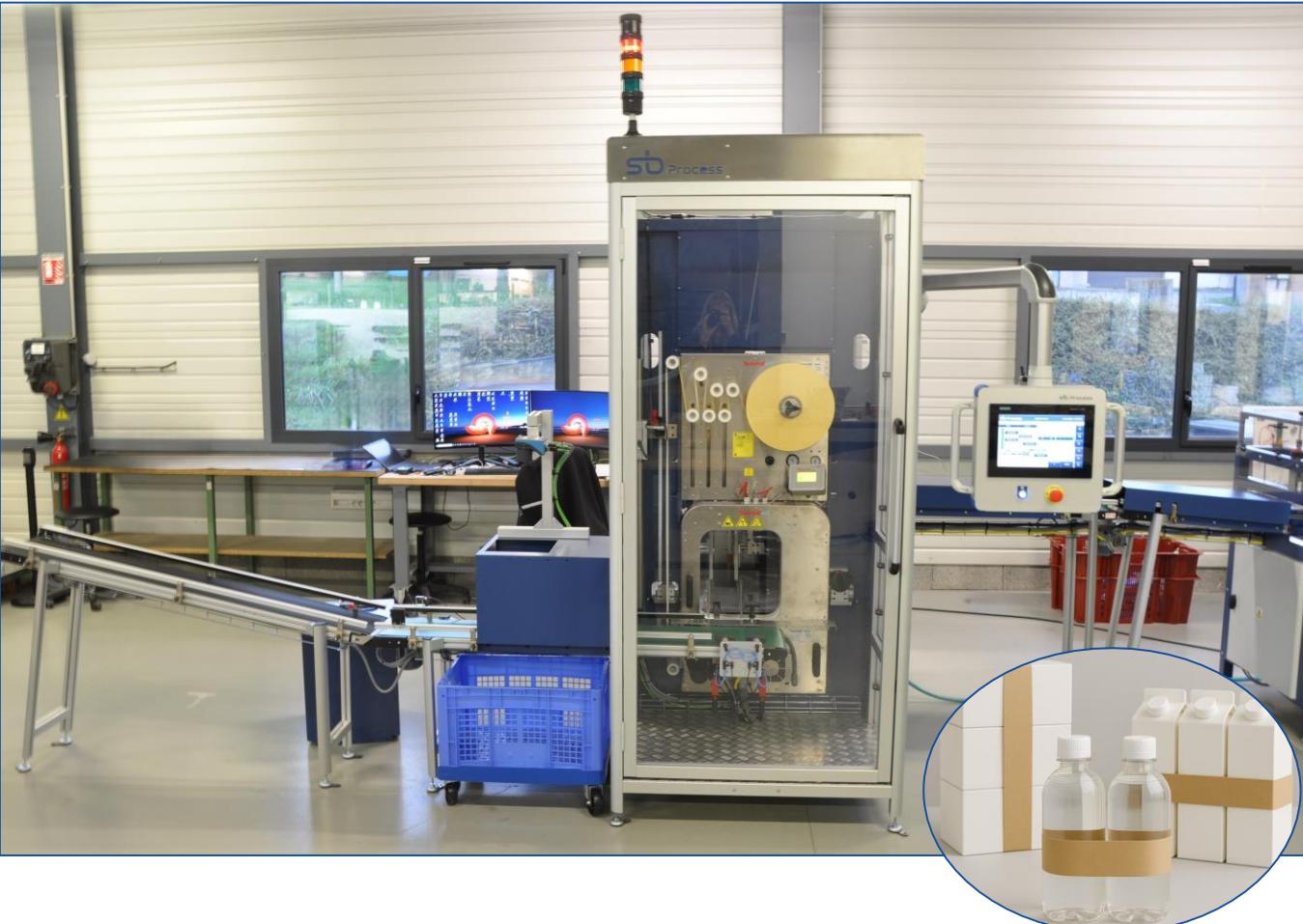
Nous avons conçu une nouvelle machine 100% automatisée pour la mise en lot et la mise sous bande papier de différents types de produits.
